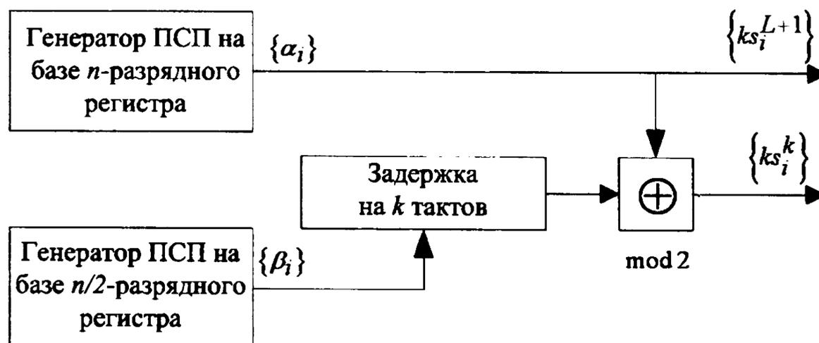
Рис. 5.9. Схема формирования последовательности Касами
