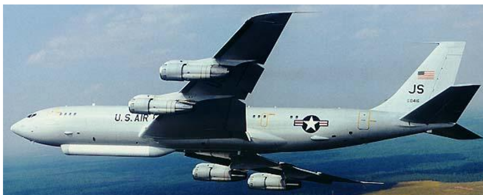
Boeing 707 JSTARS с 8 м антенной решеткой под фюзеляжем
