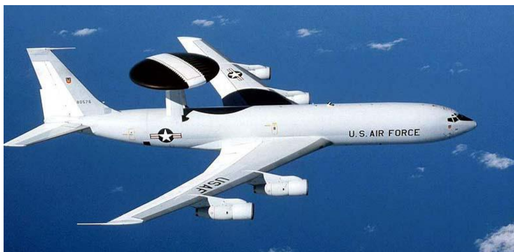
E-3C Sentry AEW (airborne early warning) с грибовидным обтекателем 9,1 м
